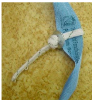
Výměna uzavírací šňůrky obalu hlavního padáku.
