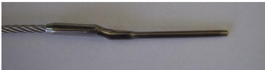
Obr. 6 Jehla lisovaná USA, plochý zális (tj. zális u lanka je zploštělý)
