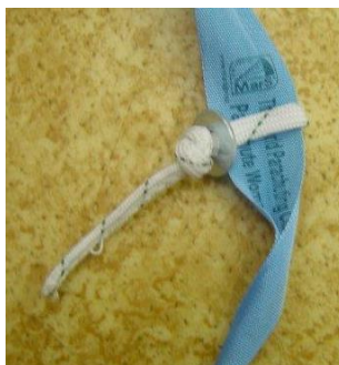
Výměna uzavírací šňůrky obalu hlavního padáku.
