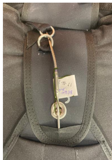
Uzavření obalu padák s AOZP. Zapojení AOZP je popsáno v technickém popise AOZP, č. P-001-21.
